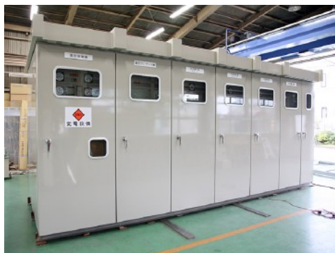
高圧受電設備
